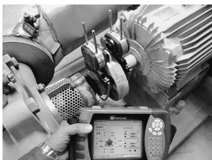
写真2 電動機のオーバーホール、軸受診断や負荷体との2軸間の芯出
