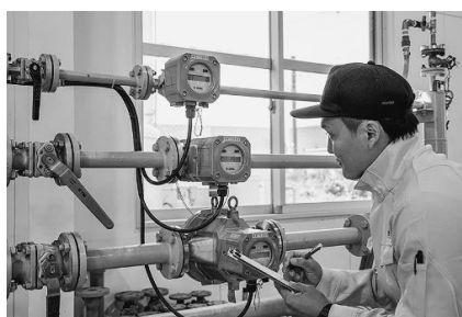
写真4 実流試験装置を備えた本社工場での計器校正サービス
